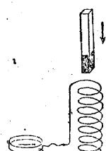
又、(3) 極の動かし方が速い時と遅い時、(4) 強い磁石を用いた時と、弱い磁石を用いた時、(5) 線輪の巻き数が多い時と少ない時とで、それぞれ電流の強さはどう変わらかを見よ。
