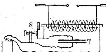
絶縁して、この上に細い銅線を非常に多数巻き付けたものを二次線輪とする。一次線輪と電池との間には、電鈴の場合と同様に、電流を断続する接点 S と、S と並列に整電器 T が入れてある。電池をつなぐと、おのずから接点が動いて電流が断続するが、電流が通り始める時より、切れる時の方が電流の変化が急なので、切れる時に、二次線輪に非常に大きな電位差が生ずる。
