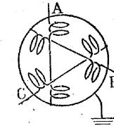
このような回轉磁界の中に、單相の時と同様な回轉子を入れたものが、工場などで廣く用いる三相誘導電動機である。
