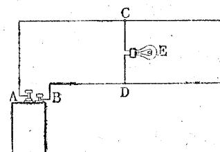
この実験において、電流の通る導線の部分 ACEDB が長くなるほど電球が暗くなることがわかるであろう。電球が暗くなるのは、電流が弱くなったためと考えられる。
