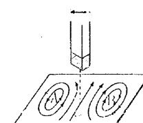
**実験** 図のように、アルミニウムの円板を面が水平になるようつるし、その下へ強い馬蹄形磁石又は電磁石の極を近づけて、磁石を鉛直軸の周りに回轉させてみよ。
