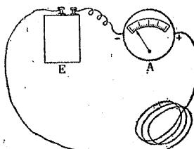
実験3 長さ、太さの共に等しい鉄線とニクロム線とを用意し、これを実験2の装置で、EとAとの間に結び、この時流れる電流の強さを比較せよ。
