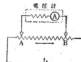
電圧計の両方の端を A 点と B 点とに接触させて用いる。
