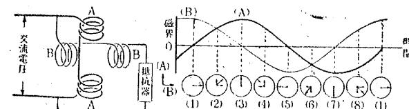
置し、A・A の方は直ちに、B・B の方は抵抗器を通して、共に交流の電源につなぐ。抵抗器を B・B と直列に入れると、それを通る電流が A・A を通る電流と、時間的に食い違って來るのである。交流ではこのような食い違いを位相の差といふ。
