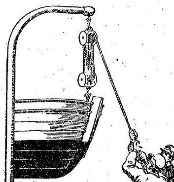
この滑車では、上方の滑車の軸は、固定していて動かない。このような滑車を「定滑車」という。
