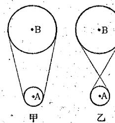
(1) 甲図のように調べ帶を掛け、A 軸を毎分 600 回の速さで右まわりに回転させると、B 軸の回転の速さはどれだけか。また、回転の向きはどうか。
