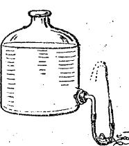
家を建てる時、土台を水平に作るために、図のような仕掛けを使っています。AとBとの水面の高さは、どんな関係がありますか。
