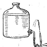
家を建てる時、土台を水平に作るために、図のような仕掛けを使っています。AとBとの水面の高さは、どんな関係がありますか。
