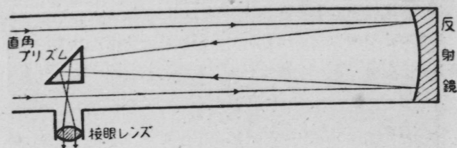
第14図 ニュートンの反射望遠鏡。実際はプリズムはこんなに大きくないから、光のはいるじゃまにはならない。
