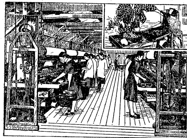
第17図 座繰機と近代製糸工場の内部
