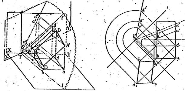
モノデアル。先ヅ、平畫面ニ垂直ナ稜ト平面  $T$  トノ交點ヲ求メテ、切り口ノ平行四邊形  $ABCD$  ノ投影圖ヲ求メル。次ニ、平畫面ハソノマトシ、立畫面ハ水平跡  $t$  ニ垂直ナ平面ヲ畫面トシテ平行四邊形  $ABCD$  ノ投影圖ヲ求メル。ソノ平面圖ハ  $abcd$  トナリ、立面圖ハ一直線上ニ並ンダ四點  $a''$ ,  $b''$ ,  $c''$ ,  $d''$  デ表サレル。更ニ、 $t$  ヲ軸ニシテ平面  $T$  ヲ回轉シ、平畫面上ニ展開シテ、切り口ノ實形  $ab.c.d$  ヲ求メル。
