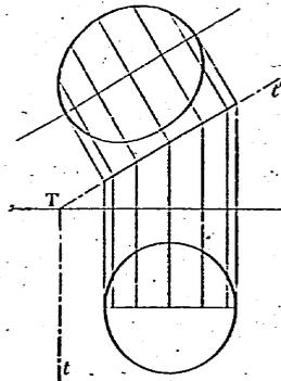
次頁ノ投影圖ハ、直方體ヲ一般ノ位置ニアル平面ヲ切ツタ時ノ切り口ノ實形ヲ求メ方ヲ示シタ
