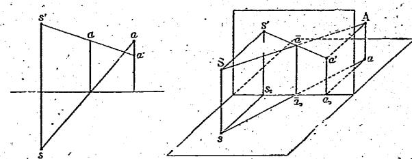
Aノ透視圖 $\bar{a}$ ハ、SAヲ含ミ平畫面ニ垂直ナ平面ト立畫面トノ交線ノ上ニアル。故ニ $sa$ ト基線トノ交點デ、基線ニ立テタ垂線ノ上ニアル。
