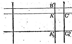
上ノ圖デ、A, B ハ同一子午線上ニアツテ、近クニアル二地點ヲ示シ、A, C ハ同一距等圈上ニアツテ、近クニアル二地點ヲ示ス。A', B', C' ハ求メル正角圖上デ、ソレヅレ A, B, C = 對應スル點ヲ示スモノトスル。明ラカニ、次ノ等式ガ成リ立タケレバナラナイ。
