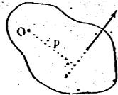
角加速度は、力の回転能に比例してゐる。力が働いても、その作用線が軸を通つてゐれば、その回転能が0になるから回転
