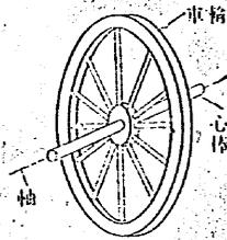
〔実験〕 1. 自転車の前の車をはづし、その心棒を水平にして支へておけ。ゴム輪に糸を附けてこれを引き、輪の回転を調べよ。回転の角速度の速くなり方を角加速度といふが、角加速度を大きくするにはどうすればよいか。またいくら引いても回転を起さないことがあるか。
